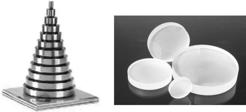
Gambar 11. a) Gauge block untuk kalibrasi b) Optical flat
