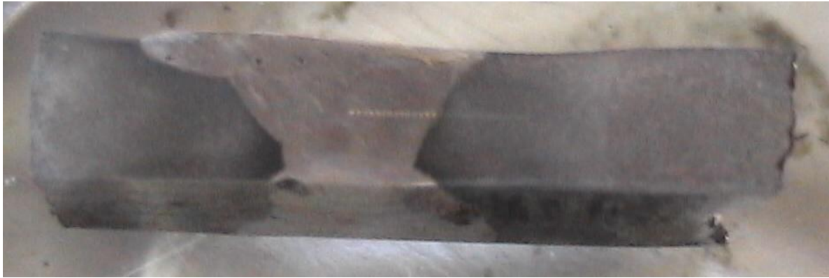
Gambar 5. Struktur makro sambungan las
