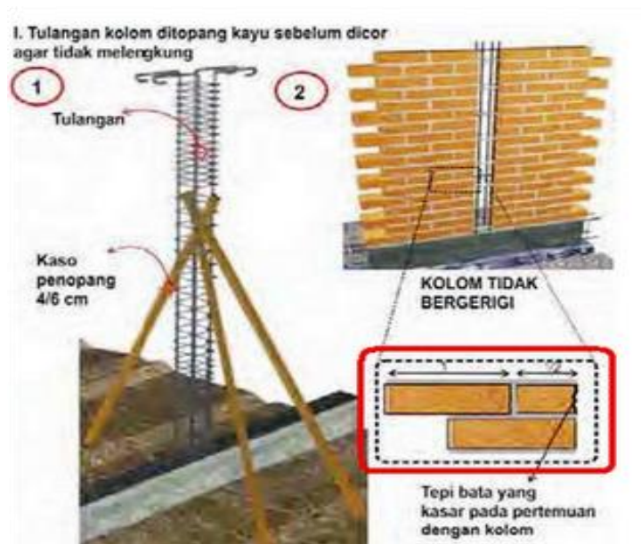
Gambar 1. : Konstruksi pemasangan kolom praktis pada dinding tembok batu bata.
