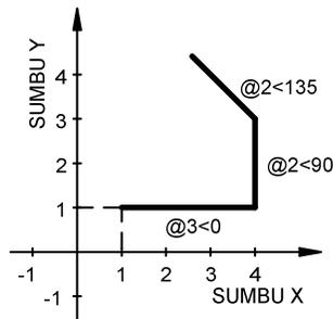
**Gambar 1.5. Hasil pembuatan garis menggunakan polar 2D**
