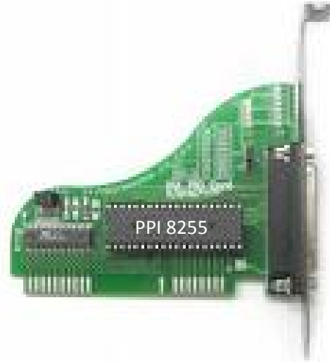
Gambar 4.12.a. Bentuk fisik PPI 8255 Sumber: www.google.co.id/images
