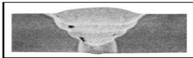
Gambar 7. Kurang peleburan (Fusi)
