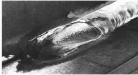
Gambar 14. Cara mengatasi keretakan crater
