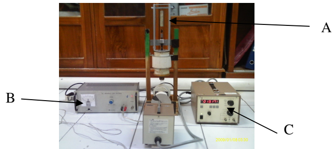
Gambar 2. Susunan alat untuk mengukur frekuensi simpangan pemaksa
