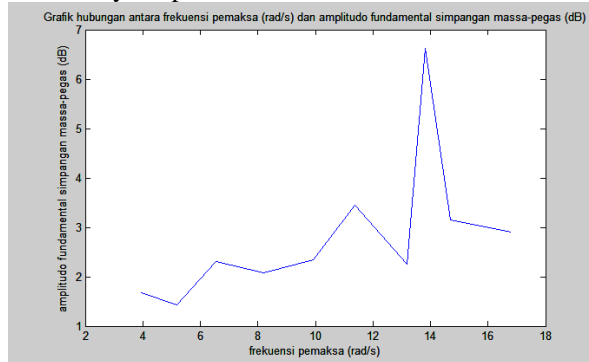
Gambar 6. Grafik hubungan antara frekuensi pemaksa (rad/s) dan amplitudo fundamental simpangan massa-pegas
