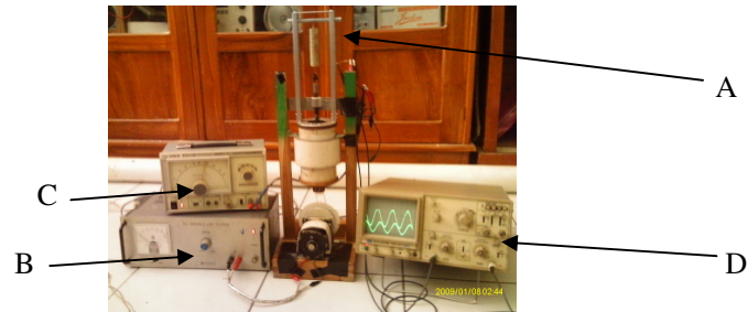
Gambar 3. Susunan alat untuk merekam beda fase
