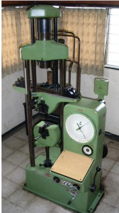
Gambar 4. Mesin alat uji tarik universal
