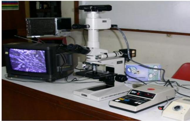
Gambar 7. Mikroskop yang dilengkapi dengan perangkat foto dan monitor.
