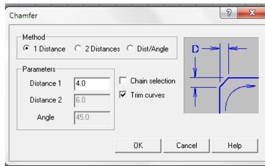
Gambar 3.7. Menu *chamfer* yang berisi metode dan parameter
