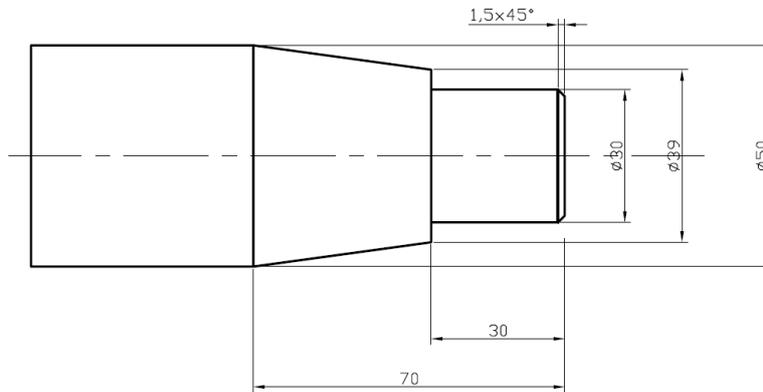
Gambar 5.2. Gambar benda kerja yang dibuat
