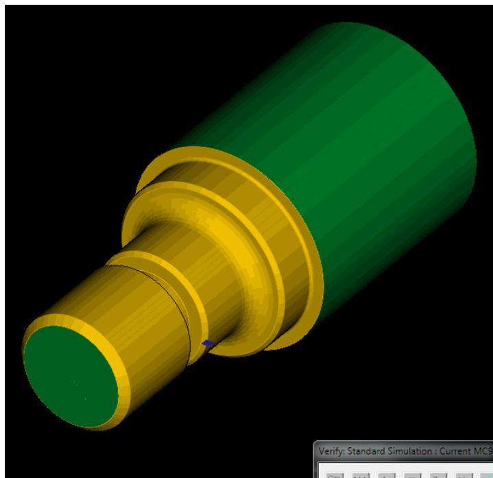
16. Proses pembuatan ulir (thread) dilakukan dengan langkah yang analog seperti langkah-langkah di atas. Beberapa parameter yang harus diisikan pada proses pemotongan ulir adalah: *tool parameters*, *thread shape parameters*, dan *thread cut parameters*, seperti gambar di bawah. Sehingga hasilnya sebagai berikut :
