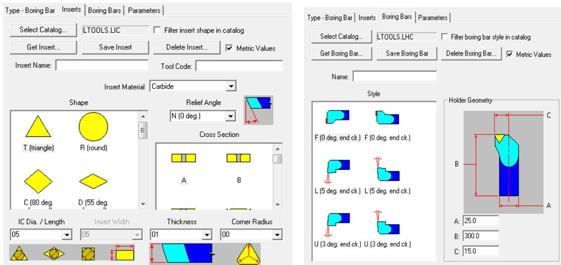
Gambar 4.12. Bentuk dan ukuran batang bor (*boring bar*) dan pemegang pahat untuk batang bor
