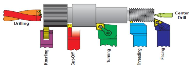
Gambar 4.2. Pahat sisipan yang dipasang pada pemegang pahat (*tool holders*), dan beberapa operasi pemesinan untuk tujuh macam jenis alat potong
