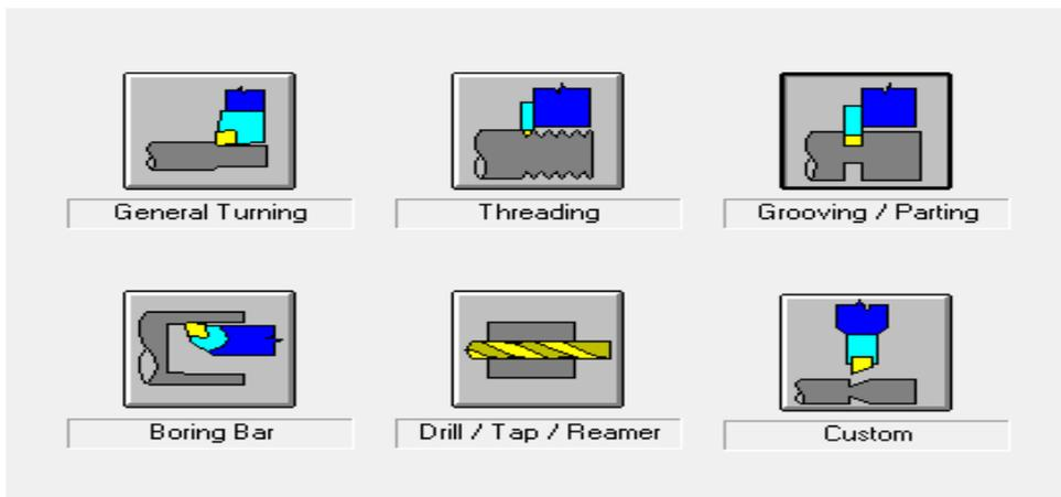
Gambar 4.6. Tipe atau kegunaan pahat bubut CNC di Mastercam Lathe 9
