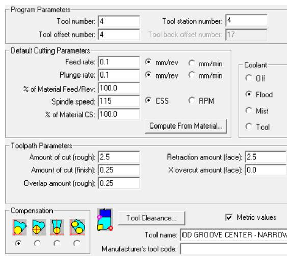
Gambar 4.9. Harga parameter yang dapat diatur pada lathe 9
