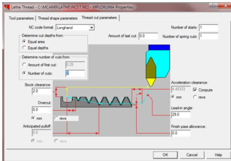
17. Setelah semua parameter tersebut di atas diisi, kemudian akan tampil simulasi pemotongan ulir. Hasil *backplot* pemotongan ulir seperti gambar di bawah.
