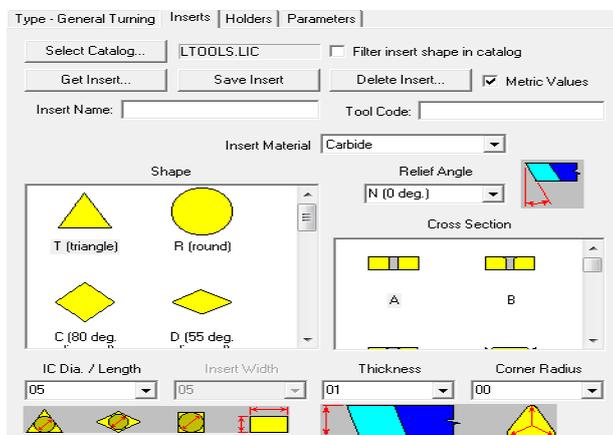
Gambar 4.7. Dimensi pahat sisipan (*inserts*) untuk mesin bubut CNC
