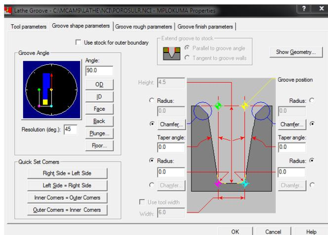
Setelah semua parameter proses pembuatan alur diisi, kemudian klik OK, maka simulasi jalannya pahat (toolpath) proses pembuatan alur akan tampil di layar. Tampilan *backplot* seperti gambar di bawah.
