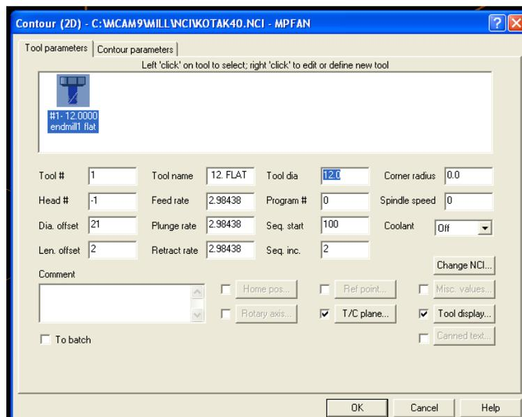
11. Kita gunakan *tool* yang sama, maka kemudian pilih *Contour parameter*. Isi data seperti gambar. Pilih *depth of cut* 2 mm. Klik *OK>OK*
