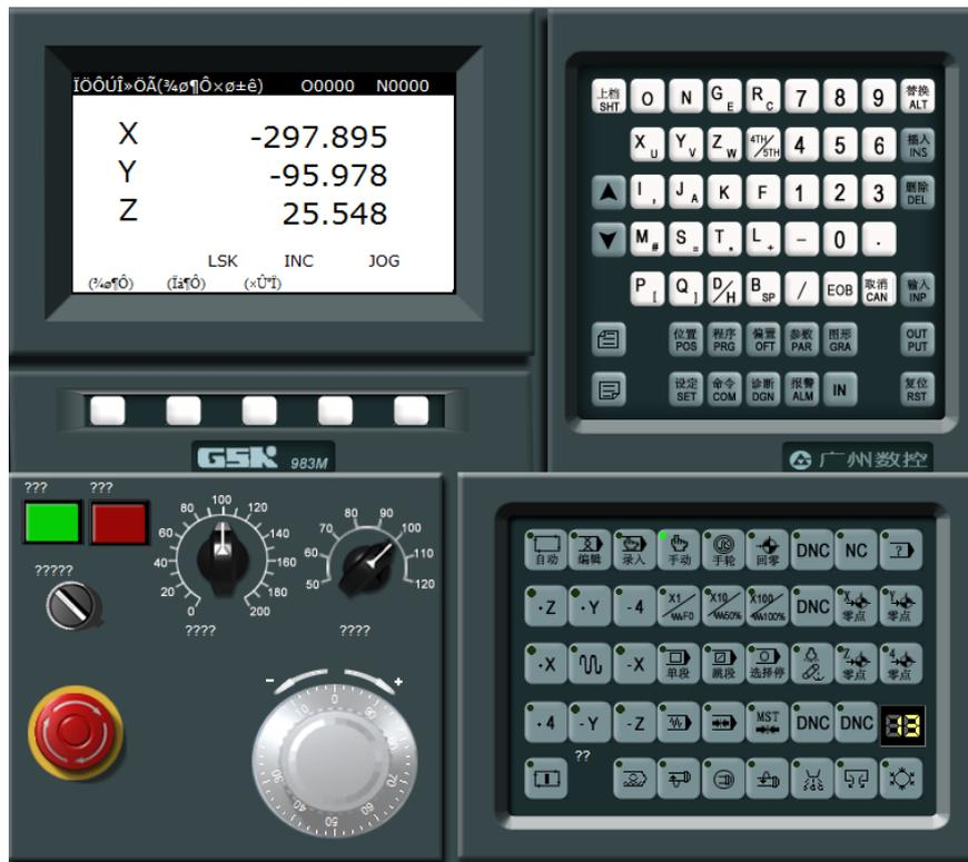
Gambar 2.28. Panel kontrol mesin frais CNC dengan sistem kontrol GSK 983
