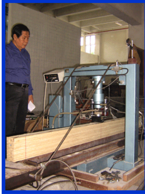
Gambar 44. Aplikasi pengujian lentur pada balok bamboo laminasi
