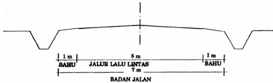
Gambar 14.1 Penampang tipikal jalan.
