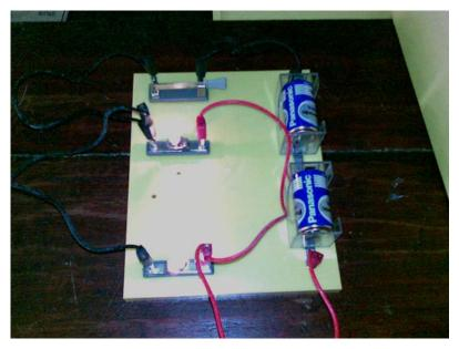
Media 1. Rangkaian listrik seri dan rangkaian listrik paralel. Fungsinya menarik perhatian dan siswa lebih memahami rangkaian seri dan rangkaian paralel. Siswa mempraktekkan dengan merangkai alat-alat tersebut sehingga terbentuk rangkaian listrik seri dan rangkaian listrik paralel.
