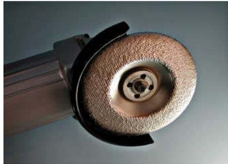
Gambar 11.10. Pemasangan Roda gerinda Pada Mesin Gerinda
