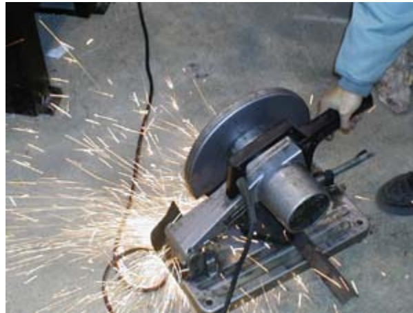
Gambar 11.23. Pekerjaan pemotongan benda kerja dengan gerinda potong
