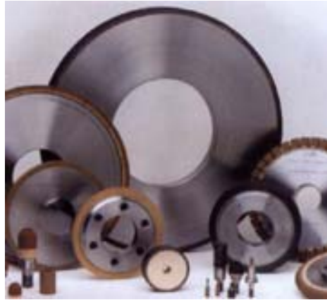
Gambar 11.12. Roda gerinda dari bahan diamond
