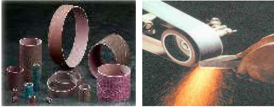
Gambar 11.8. Amplas roll dan menggunakan dengan mesin
