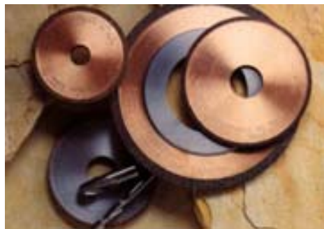
Gambar 11.13. Roda gerinda dari bahan cubic boron nitride
