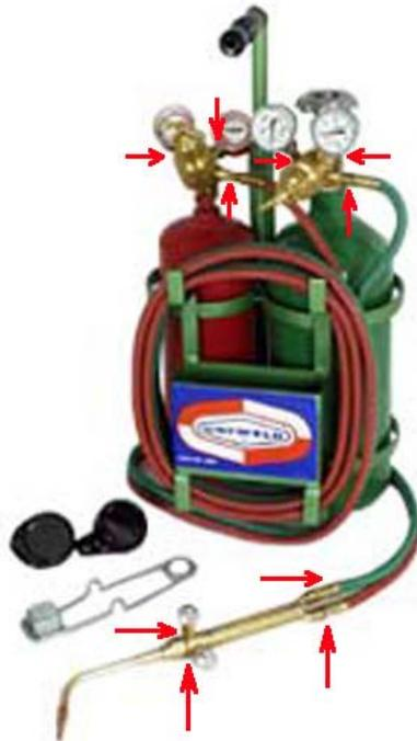
Gambar 7.37. Posisi Pemeriksaan Kebocoran Instalasi Las
