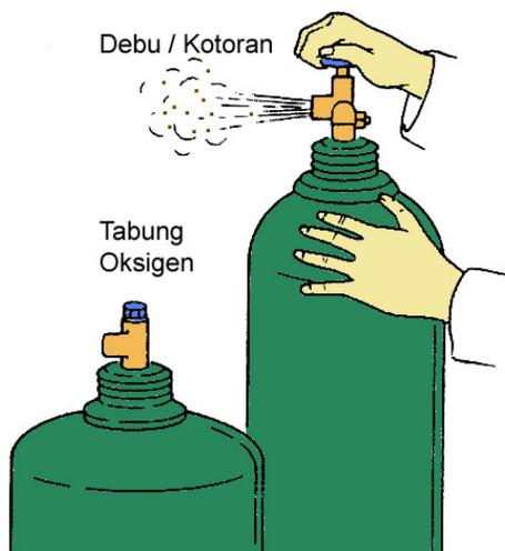
Gambar 7.15. Membuang kotoran di dalam katup tabung oksigen
