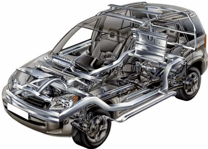
Gambar 1.1 Konstruksi Bodi Otomotif
