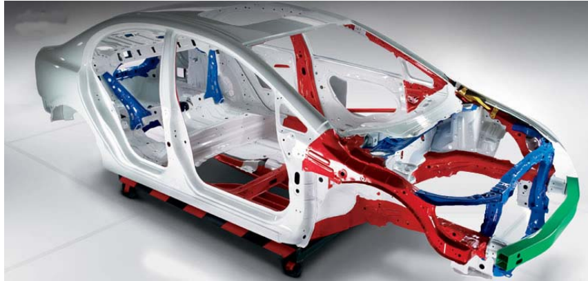
Gambar 1.6. Konstruksi Bodi Integral ( Monocoque Body )
