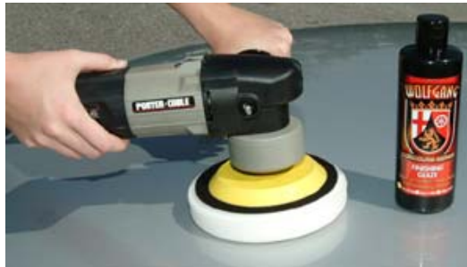
Gambar 1.26. Polishing menghilangkan goresan pada cat
