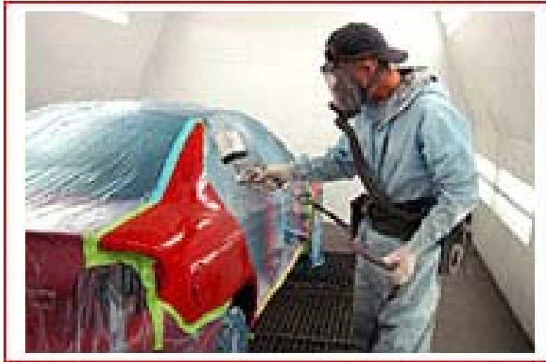
Gambar 1.24. Pengecatan bodi mobil
