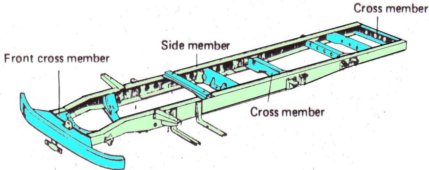
konstruksinya sangat sederhana, mudah dibuat, banyak digunakan untuk kendaraan bus, truck.
