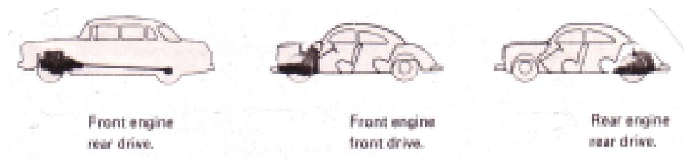
Gambar 12. Tipe-tipe mesin penggerak terhadap pemindah tenaga
