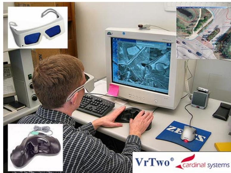
Gambar 68. Seperangkat komputer sebagai workstation untuk pemrosesan fotogrametri digital
