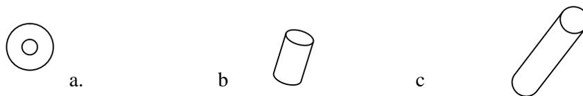
Gambar 12. Ilustrasi kenampakan sebuah menara yang sama pada foto udara dengan posisi yang berbeda
