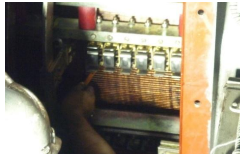
Gambar 7: Pembersihan komutator menggunakan gergaji besi
