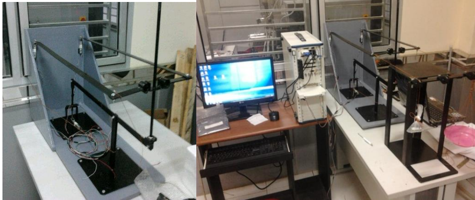
Gambar 4. Prototipe pengukur gaya dan momen
