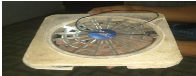
Gambar 5. Papan Partikel Sebagai Dudukan Cooling Fan
