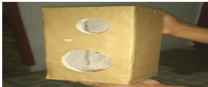
Gambar 6. Papan Partikel Sebagai Kotak Speaker
