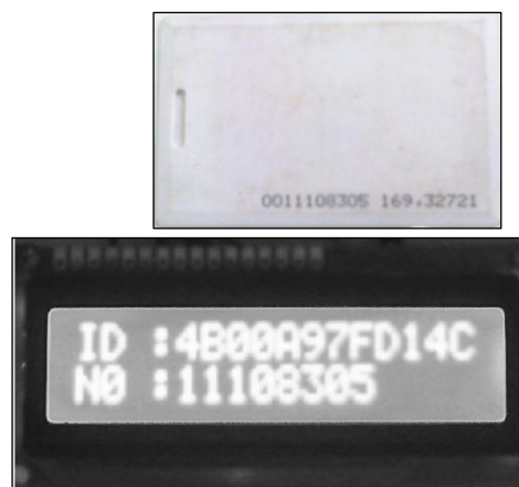
Gambar 10. Hasil pengujian penerimaan jumlah paket data dan konversi nilainya. Sumber : hasil penelitian
