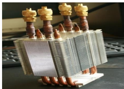
Gambar 6 Aplikasi pipa kalor pada pendingin prosesor komputer.
