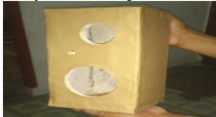
Gambar 6. Papan Partikel Sebagai Kotak Speaker
