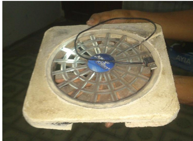
Gambar 5. Papan Partikel Sebagai Dudukan Cooling Fan
