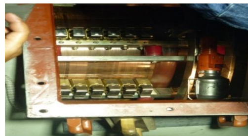
Gambar 9: Comutator pada motor 2000 KW
