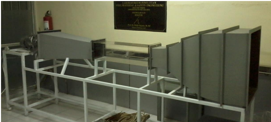
Gambar 1. Terowongan Angin jenis terbuka di Prodi Teknik Mesin UNJ
