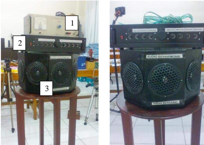
Gambar-7 Instrumentasi teknologi tepat guna audio bio harmonic untuk meningkatkan produktivitas tanaman kentang.
