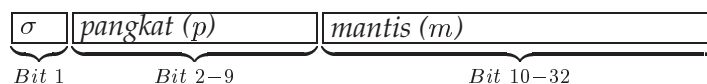
Gambar 1.2: Alokasi bit tanda ( \sigma ), mantis ( m ) dan pangkat ( p ) pada komputer DEC VAX dengan 32-bit titik-mengambang
