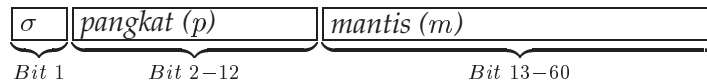
Gambar 1.1: Alokasi bit tanda ( \sigma ), mantis ( m ) dan pangkat ( p ) pada komputer CDC dengan 60-bit titik-mengambang
