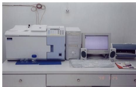
**Gambar 3. Kromatografi Gas.** Digunakan untuk mengetahui kadar residu bahan aktif (mutu formulasi pestisida) yang beredar di lapangan. Mengetahui kadar residu pestisida dalam hasil pertanian, peternakan, perikanan, tanah, air limbah, makanan, minuman, muntahan dan cairan lambung.
