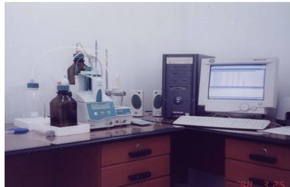
**Gambar 2. Karl Fisher Titrator.** Digunakan untuk mengetahui kadar air, pestisida, hasil pertanian, oli, lemak CPO (Crude Palm Oil) dsb. Pengukuran dapat dicetak melalui komputer, persentase kesempurnaan pengukuran dapat terbaca di display alat maupun pada layar monitor komputer dan satuan hasil analisis dapat di set dalam bentuk %, gram dan ml.
