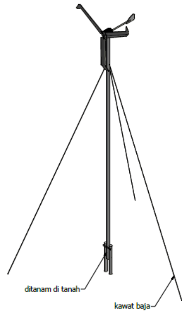
Gambar. Desain Tiang dan pondasi Kincir Angin.
