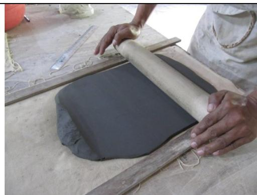
**Gambar 6.** Proses Pembuatan *Tile Uji* Campuran Lumpur Lapindo dan Abu Gunung Merapi.
