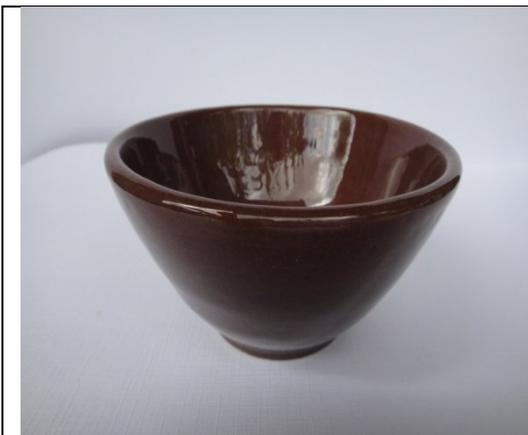
**Gambar 15.** Contoh *Prototype* Produk Bakaran Tinggi dengan Diglasir.
