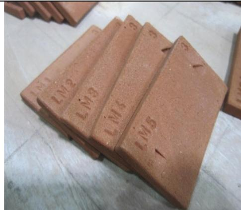
**Gambar 8.** Contoh *Tile Uji* Campuran Lumpur Lapindo dan Abu Gunung Merapi yang Selesai Dibakar.
