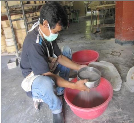
**Gambar 3.** Proses Penyaringan Lumpur Lapindo
