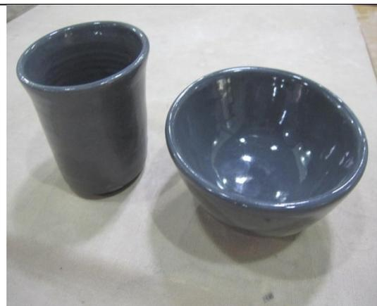
**Gambar 16.** Contoh *Prototype* Produk Bakaran Tinggi dengan Diglasir.
