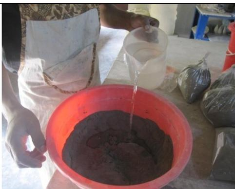
**Gambar 5.** Proses Pembuatan Adonan Lumpur Lapindo dan Abu Gunung Merapi.
