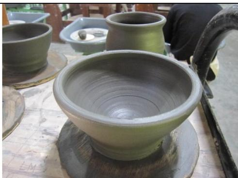
**Gambar 11.** *Prototype* Produk yang Siap Dikeringkan.
