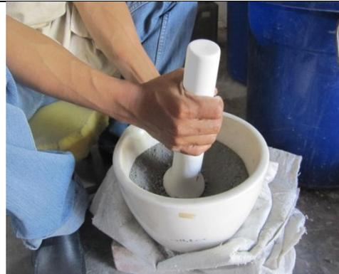
**Gambar 2.** Proses Penumbukan Lumpur Lapindo.
