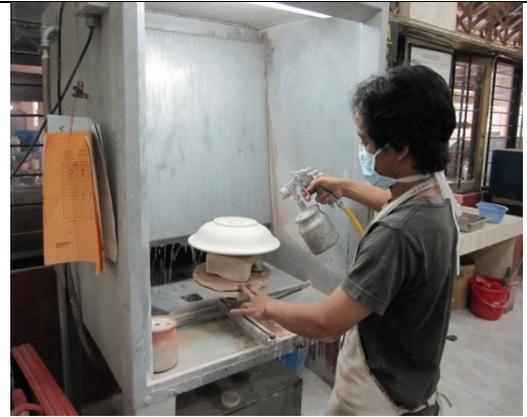
**Gambar 14.** Proses Pengglasiran *Prototype* Produk.
